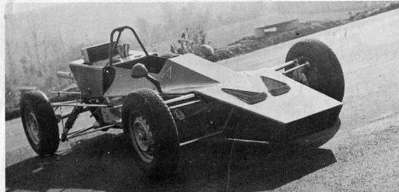
La Poponi F. 850 ha una linea moderna e piacevole. La vettura è stata completamente costruita (telaio, carrozzeria, portamozzi) dal signor Poponi, nella sua officina
