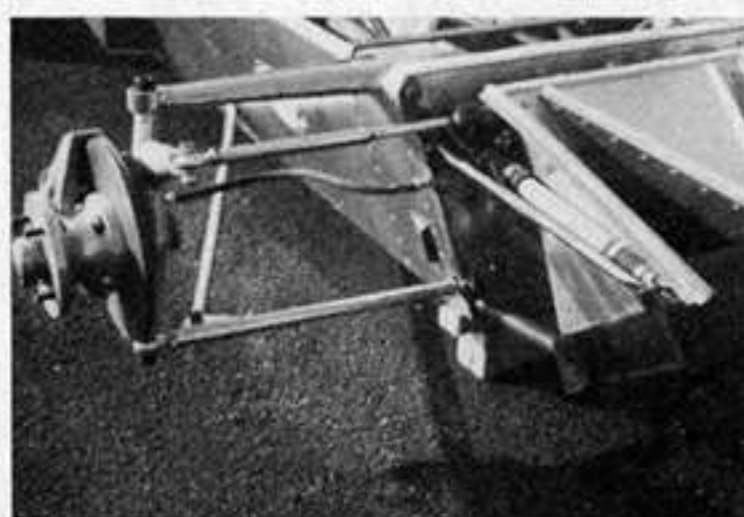
Sopra, la sospensione posteriore della Poponi F. 850 e (sotto) quella anteriore
