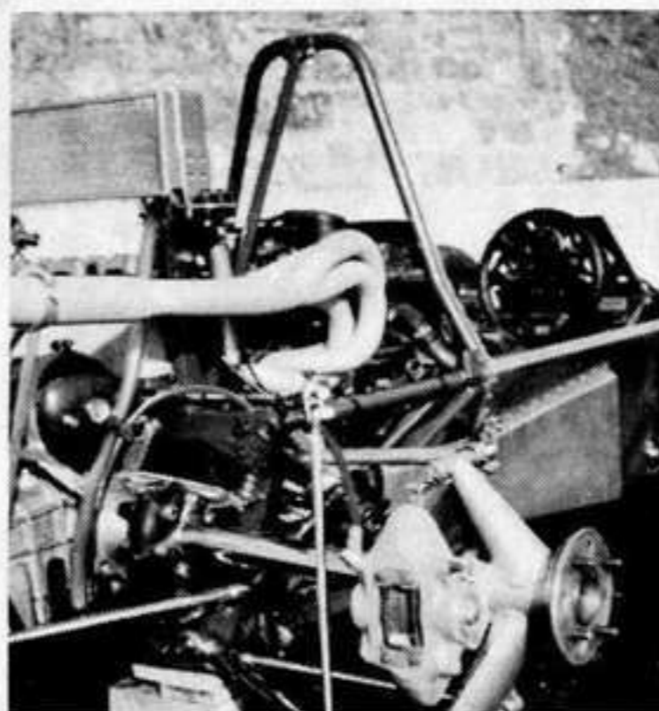
Sopra, la sospensione posteriore della Poponi F. 850 e (sotto) quella anteriore
