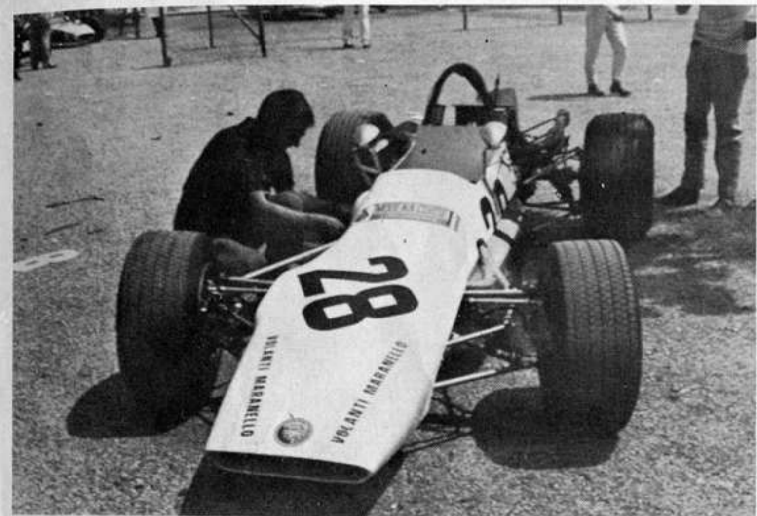
Primi passi della Gozzoli: si può notare la sospensione anteriore di tipo tradizionale, i serbatoi bassi e il motore Ford Novamotor. La carrozzeria è già in vetroresina, anche se ancora molto grezza
