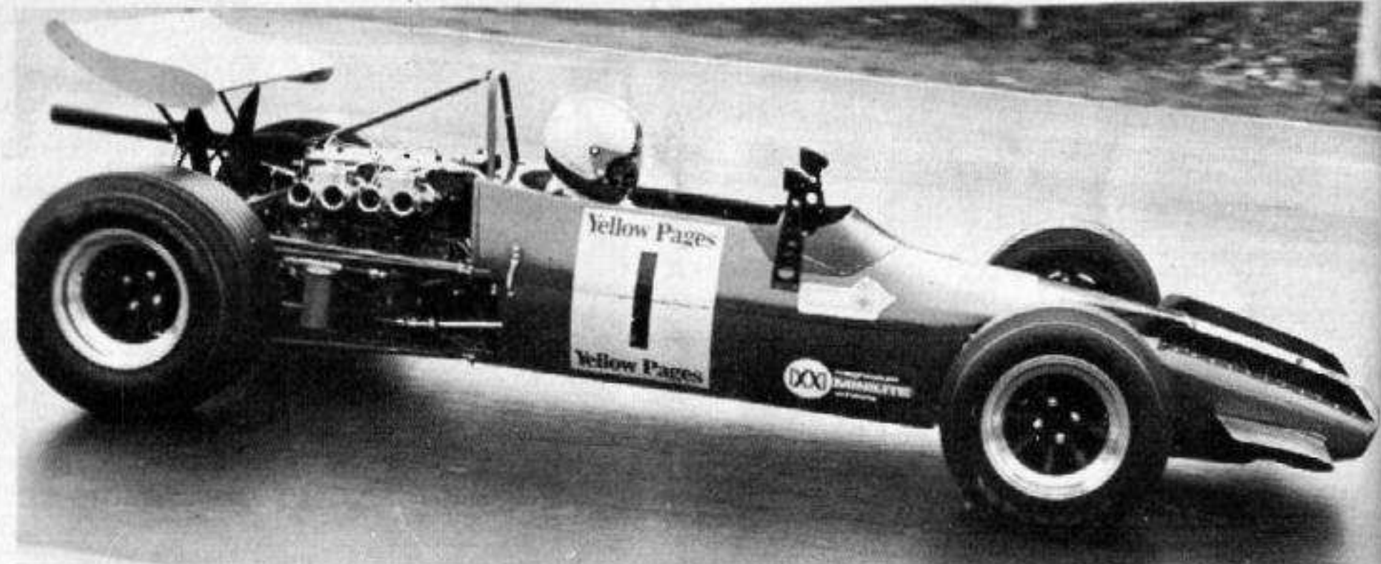
ROYALE RP8. Questa vettura con telaio tubolare ha per ora dato le premesse migliori del potenziale della Formula Atlantic, dato che il prototipo ha corso in gare autunnali di Formula Libera. Con un motore Ford TC di 160 HP Ray Allen ha girato sul circuito corto di Brands Hatch in 48"8. Da allora questa vettura da sviluppo è stata equipaggiata con un motore BDA messo a punto dalla Steele, che eroga 200 HP, e si dice che sia possibile segnare circa 46" sul giro
