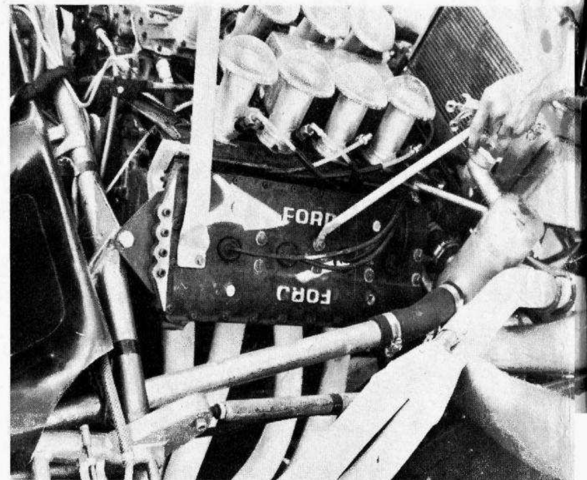
Ecco il motore Ford, uguale a quello usato dalle F. 1. Il telaio è rimasto tubolare, molto semplice e robusto, mentre modifiche sono state apportate alle sospensioni (con nuove gomme) ed al peso, che è calato di 80 kg in totale, raggiungendo il traguardo di 590 kg
